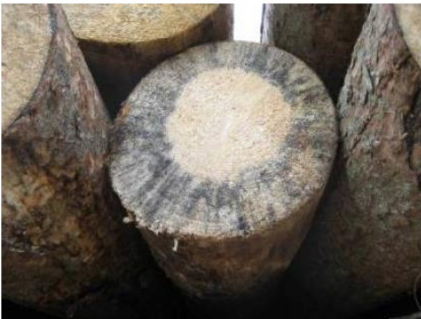
Abb. 6: Tief eingelaufene Verfärbungen
